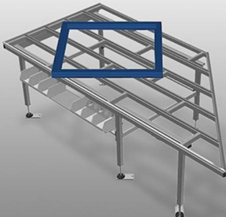
Mesa horizontal para todos los trabajos en marcos y hojas. Construcción estable de acero. Mesa de trabajo angular, puede utilizarse como zona de paso en la línea de producción o como zona intermedia. Mesa de montaje para todos los trabajos en marcos y hojas. Superficie de apoyo de la mesa con barras deslizantes de plástico. Bandeja de almacenamiento para depositar herramientas y accesorios. Altura regulable. Instalación sencilla con un diseño de sistema modular.
