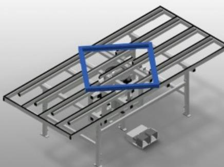
Mesa elevadora y giratoria para el montaje y la inserción de juntas. Construcción estable de acero. Ideal para el montaje y la inserción de juntas. Altura regulable. Altura de la mesa interior ajustable neumáticamente. Mesa interior giratoria; con freno de fijación neumático. Mesa interior equipada con tiras de goma. Mesa exterior con barras de deslizamiento de plástico. Suministro de aire comprimido cuádruple.
