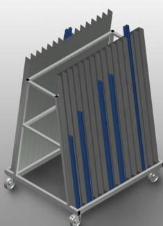
Carro de junquillos para el transporte y la clasificación de junquillos. Construcción estable de acero. Ideal para el transporte vertical y la clasificación de junquillos. Carro para junquillos con 30 compartimentos. 15 compartimentos por lado. Superficie de apoyo inferior revestida de goma. Cuatro ruedas, dos de ellas con freno de fijación.
