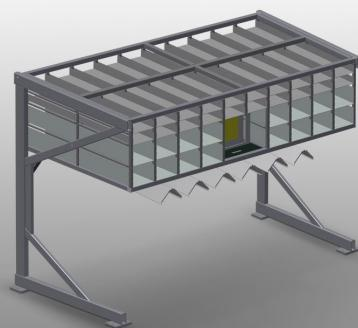
Estantería de herrajes con 36 compartimentos para el almacenamiento ordenado de los herrajes en el puesto de montaje de la hoja. Construcción estable de acero. Con seis soportes angulares para los engranajes de las esquinas. Espacio para un monitor, con soporte para teclado.
