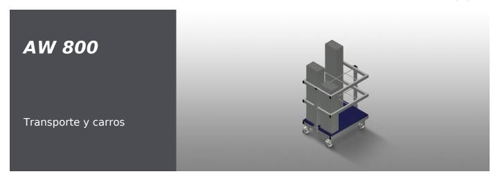
Carro para transportar y proporcionar una selección ordenada de perfiles de refuerzo cortados a medida. Construcción de acero estable. Almacenamiento y transporte vertical de perfiles de acero. Dimensiones exteriores compactas. Disposición bien organizada de los perfiles de longitud fija. Cuatro ruedas, dos de ellas con freno de fijación.
