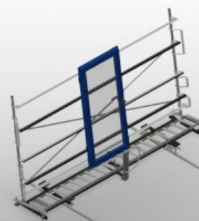
Stabile Stahlkonstruktion. Vertikale Rollenbahn für fließenden Transport zur nächsten Bearbeitung, sowie auch für den Transport zur Lagerung und Sortierung der fertigen Fenster. Einfaches Handling von Fensterelementen. Jede Rollenbahneinheit 4.000 mm lang. Kunststoff-Gleitleisten oben und unten. Drei Röllchenbahnen mit Gummi-Rollen, Durchmesser 50 mm. Grundeinheit mit Endständern. Vertikale Rollenbahn auf Schienen mit Spurkranzräder, fahrbar. Rollenbahn ist 360° drehbar.
