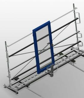
Stabile Stahlkonstruktion. Vertikale Rollenbahn für fließenden Transport zur nächsten Bearbeitung, sowie auch für den Transport zur Lagerung und Sortierung der fertigen Fenster. Einfaches Handling von Fensterelementen. Jede Rollenbahneinheit 4.000 mm lang. Kunststoff-Gleitleisten oben und unten. Drei Röllchenbahnen mit Gummi-Rollen, Durchmesser 50 mm. Grundeinheit mit Endständer. Vertikale Rollenbahn auf Schienen mit Spurkranzräder, fahrbar. Rollenbahn ist 360° drehbar.
