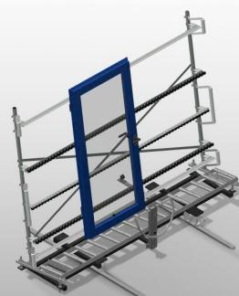
Rollenbahn vertikal für Transport von Fensterelementen. Stabile Stahlkonstruktion. Vertikale Rollenbahn für fließenden Transport zur nächsten Bearbeitung sowie auch für den Transport zur Lagerung und Sortierung der fertigen Fenster. Einfaches Handling von Fensterelementen. Jede Rollenbahneinheit 3.000 mm lang. Kunststoff-Gleitleisten oben und unten. Drei Röllchenbahnen mit Gummi-Rollen, Durchmesser 50 mm. Grundeinheit mit Endständen. Vertikale Rollenbahn auf Schienen mit Spurkranzrädern fahrbar.
