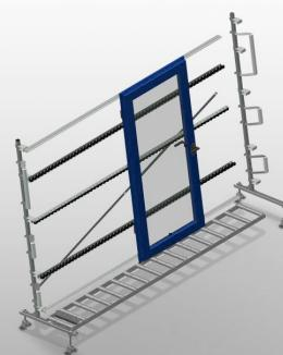
Rollenbahn vertikal für Transport und Lagerung von Fensterelementen. Stabile Stahlkonstruktion. Erweiterung im Baukastensystem. Vertikale Rollenbahn für fließenden Transport und Lagerung von Fensterelementen. Einfaches Handling von Fensterelementen. Jede Rollenbahneinheit 3.000 mm lang. Rollenbahn 3-fach geteilt. Kunststoff-Gleitleisten oben und unten. Drei Röllchenbahnen mit Gummi-Rollen, Durchmesser 50 mm. Grundeinheit ohne Endständer.
