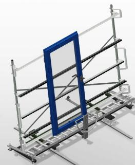
Stabile Stahlkonstruktion. Vertikale Rollenbahn für fließenden Transport zur nächsten Bearbeitung, sowie auch für den Transport zur Lagerung und Sortierung der fertigen Fenster. Einfaches Handling von Fensterelementen. Jede Rollenbahneinheit 3.000 mm lang. Kunststoff-Gleitleisten oben und unten. Drei Röllchenbahnen mit Gummi-Rollen, Durchmesser 50 mm. Grundeinheit mit Endständern. Vertikale Rollenbahn auf Schienen mit Spurkranzräder, fahrbar. Rollenbahn ist 360° drehbar.
