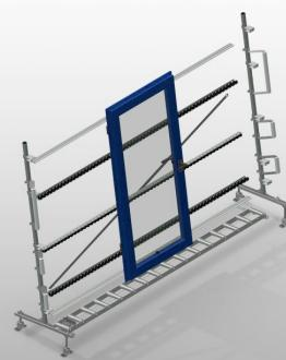
Rollenbahn vertikal für Transport und Lagerung von Fensterelementen. Stabile Stahlkonstruktion. Erweiterung im Baukastensystem. Vertikale Rollenbahn für fließenden Transport und Lagerung von Fensterelementen. Einfaches Handling von Fensterelementen. Jede Rollenbahneinheit 3.000 mm lang. Kunststoff-Gleitleisten oben und unten. Drei Röllchenbahnen mit Gummi-Rollen, Durchmesser 50 mm. Grundeinheit ohne Endständer.
