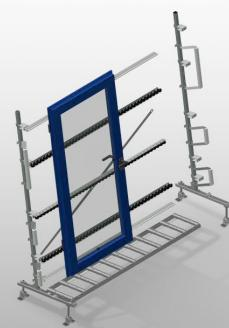
Rollenbahn vertikal für Transport und Lagerung von Fensterelementen. Stabile Stahlkonstruktion. Erweiterung im Baukastensystem. Vertikale Rollenbahn für fließenden Transport und Lagerung von Fensterelementen. Einfaches Handling von Fensterelementen. Jede Rollenbahneinheit 2.000 mm lang. Rollenbahn 3-fach geteilt. Kunststoff-Gleitleisten oben und unten. Drei Röllchenbahnen mit Gummi-Rollen, Durchmesser 50 mm. Grundeinheit ohne Endständer.
