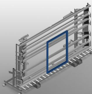
Kontroll- und Verglasungseinheit für das Verglasen und die Endkontrolle in Einzelund und Serienfließfertigung. Schnelle, exakte Fenster-, Türen- und Elementenmontage. Stabile Stahlkonstruktion. Genauigkeit durch parallele Spannbalkenpressung. Stufenlose Höhenverstellung. Einfache Handhabung durch Fußschalter. Zwei pneumatisch abklappbare und verfahrbare Pressbalken und Druckluftanschluss 4-fach.
