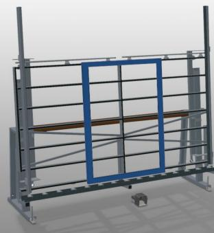
Kontroll- und Verglasungseinheit für das Verglasen und die Endkontrolle. Schnelle, exakte Fenster-, Türen- und Elementenmontage. Stabile Stahlkonstruktion. Genauigkeit durch parallele Spannbalkenpressung mit manuell abschwenkbaren Pressbalken. Einfache Handhabung durch Fußschalter. Pneumatische Mittenzentrierung, ablage für Werkzeug und Druckluftanschluss 4-fach.
