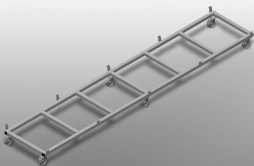
Stabile Stahlkonstruktion. Transportwagen zur Beförderung von Profilkassetten. Ideal für den Transport der Profilkassetten vom Lager bis zur Säge oder zum Bearbeitungszentrum. Für Profilpaletten bis 760 mm Breite. Sicherungslaschen zur Palettensicherung. Sechs Rollen, vier Lenkrollen mit Feststellbremse und zwei Bockrollen.
