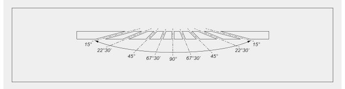
Mechanische Einstellung der Zwischenwinkel
