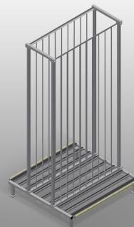
Regal für die Lagerung von Rahmenelementen. Stabile Stahlkonstruktion. Regal für die Lagerung von Rahmen. Die Elemente stehen einzeln direkt zu Verfügung. Speziell für die Integrierung in Montagelinien entwickelt. Zugriff von beiden Seiten möglich. Bodenauflage mit Pilzprofil belegt. Fachtrennstäbe mit Schutzschlauch bezogen. Aufstellfläche mit Rollen für noch einfacheres Be- und Entladen.
