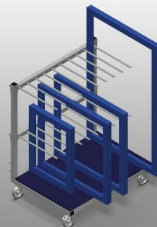
Profilwagen für innerbetrieblichen Transport von Rahmen und Flügeln. Stabile Stahlkonstruktion. Wagen mit Sortierkamm zum Transport und zur Lagerung von Rahmen und Flügeln. Hartholzauflage. Fachteiler für neun Rahmen. Fachteiler in der Höhe verstellbar. Vier Lenkrollen, davon zwei mit Feststellbremse.
