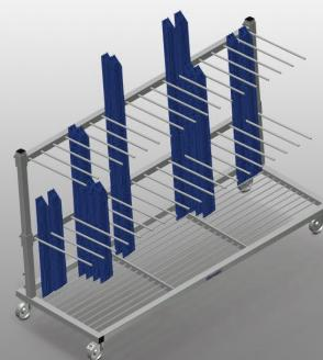
Profilwagen für die senkrechte Lagerung und den Transport von Profilen. Stabile Stahlkonstruktion. Senkrechter Profiltransport. Einseitig zu beladender Profilwagen. Einfaches Be- und Entladen. Ausreichend für 60 – 80 Profilstäbe. Fachteiler höhenverstellbar. Aufstellfläche als Stabrasterboden. Vier Lenkrollen, davon zwei mit Feststellbremse.
