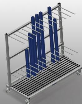
Profilwagen für die senkrechte Lagerung und den Transport von Aluminium-Profilen. Stabile Stahlkonstruktion. Ideal für den Transport und platzsparende Zwischenlagerung von Profilzuschnitten. Senkrechter Profiltransport. Ausreichend für 12 - 60 Profilstäbe. Fachteiler in der Höhe verstellbar. Untere Auflage mit Gummileisten. Fachteiler mit Schutzschlauch. Rückseitige Anlage mit Gummileisten. Vier Lenkrollen, davon zwei mit Feststellbremse.
