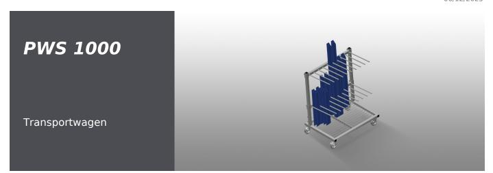
Profilwagen für die senkrechte Lagerung und den Transport von Profilen. Stabile Stahlkonstruktion. Senkrechter Profiltransport. Einseitig zu beladender Profilwagen. Einfaches Be- und Entladen. Ausreichend für 30 – 40 Profilstäbe. Fachteiler in der Höhe verstellbar. Aufstellfläche als Stabrasterboden. Vier Lenkrollen, davon zwei mit Feststellbremse.
