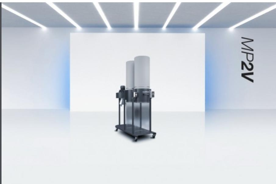
PVC-Späneansaugsystem für die Arbeitseinheit von einfachen Gehrungssägen. Schallgedämmter Spänesauger mit einem Saugstutzen, geeignet auch für Dauerbetrieb. Hochleistungsgebläse mit Motor 1,5 (kW). Sammelsystem des angesaugten Materials mit Beutel aus Nylon 180 Liter, mit Schnellauskupplungssystem für das einfache und schnelle Entsorgen des angesaugten Materials.
