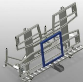
Montagetisch für vertikale und horizontale Montage. Stabile Stahlkonstruktion. Wichtig beim Wechsel vom vertikalen zum horizontalen Transport und umgekehrt. Ideal für vertikale und horizontale Montage. Pneumatisch kippbar. Tischauflage mit Kunststoff-Gleitleisten. Rollenauflage pneumatisch absenkbar. Druckluftanschluss 4-fach.
