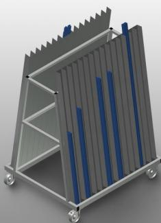
Glasleistenwagen für Transport und Sortierung von Glasleisten. Stabile Stahlkonstruktion. Ideal für vertikalen Transport und Sortierung von Glasleisten. Glasleistenwagen mit 30 Fächern. 15 Fächer pro Seite. Auflage unten mit Gummi belegt. Vier Lenkrollen, davon zwei mit Feststellbremse.
