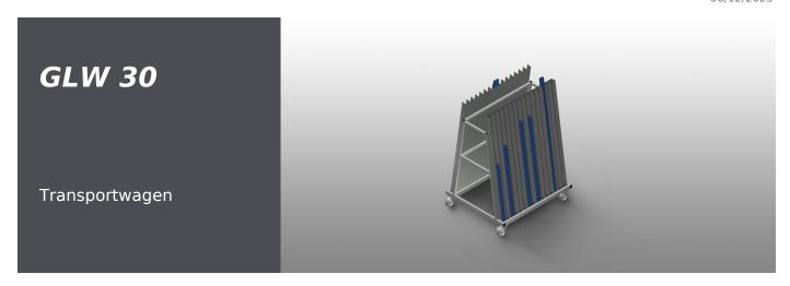
Glasleistenwagen für Transport und Sortierung von Glasleisten. Stabile Stahlkonstruktion. Ideal für vertikalen Transport und Sortierung von Glasleisten. Glasleistenwagen mit 30 Fächern. 15 Fächer pro Seite. Auflage unten mit Gummi belegt. Vier Lenkrollen, davon zwei mit Feststellbremse.
