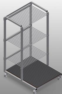
Stabile Stahlkonstruktion. Ideal zur Glassortierung. Hartholzauflage mit Filz. Fachteiler für 20 Glasscheiben. Fachteiler höhenverstellbar. Vier Lenkrollen, davon zwei mit Feststellbremse.
