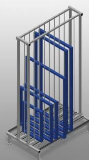
Regal für die Lagerung von Fensterelementen. Stabile Stahlkonstruktion. Regal für die Lagerung von Fensterflügeln. Die Elemente stehen einzeln direkt zur Verfügung. Speziell für die Integrierung in Montagelinien entwickelt. Zugriff von beiden Seiten möglich. Auflagefläche mit Tragrollen für noch einfacheres Be- und Entladen. Fachtrennstäbe mit Schutzschlauch bezogen.
