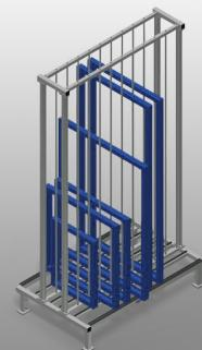
Regal für die Lagerung von Fensterelementen. Stabile Stahlkonstruktion. Regal für die Lagerung von Fensterflügeln. Die Elemente stehen einzeln direkt zur Verfügung. Speziell für die Integrierung in Montagelinien entwickelt. Zugriff von beiden Seiten möglich. Auflagefläche mit Tragrollen für noch einfacheres Be- und Entladen. Fachtrennstäbe mit Schutzschlauch bezogen.
