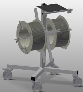
Dichtungswagen für die Aufnahme von Dichtungsrollen. Stabile Stahlkonstruktion. Aufnahme für zwei Haspeln. Unentbehrlich beim Dichtungseinziehen. Einstellmöglichkeit für jeden Haspeldurchmesser. Werkzeugablage. Vier Lenkketten, davon zwei mit Feststellbremse.
