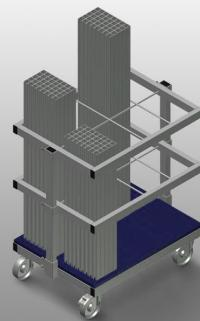
Wagen für Transport und sortierte Bereitstellung von zugesägten Armierungsprofilen. Stabile Stahlkonstruktion. Vertikale Lagerung und Transport von Stahlprofilen. Geringe Außenabmessung. Übersichtliche Profilanordnung für Fixlängen. Vier Lenkketten, davon zwei mit Feststellbremse.
