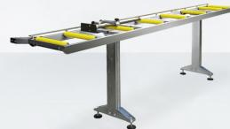
Gestell aus Strahlrohr mit verstellbaren Füßen und Tragrollen aus Stahl mit PVCBezug. Bei 240 mm Rollen beträgt die Länge der Rollenbahn 3.500 mm.
